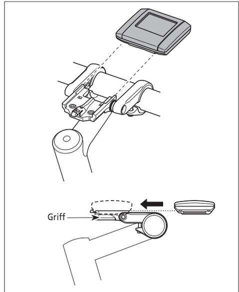
Um das Display zu entfernen, drücken Sie fest auf den Hebel der Halterung, während Sie das Display herauschieben.
