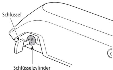
2. Zum Entriegeln des Akkus drehen Sie den Schlüssel, bis Sie etwas Widerstand feststellen.
